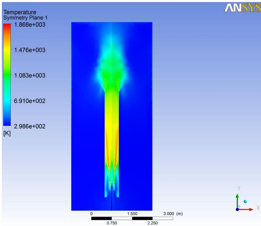
Temperatura di combustione
