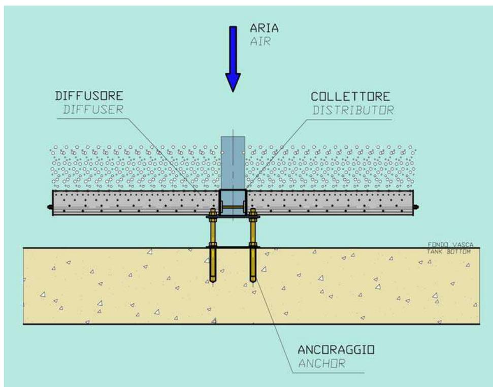
Inoltre, durante il funzionamento i diffusori **DBMT** creano un ampio tappeto d'aerazione, continuo ed uniforme, che agevola la miscelazione e l'efficienza nel trasferimento d'ossigeno, e riduce le zone morte in cui si possono depositare le particelle solide più pesanti.
