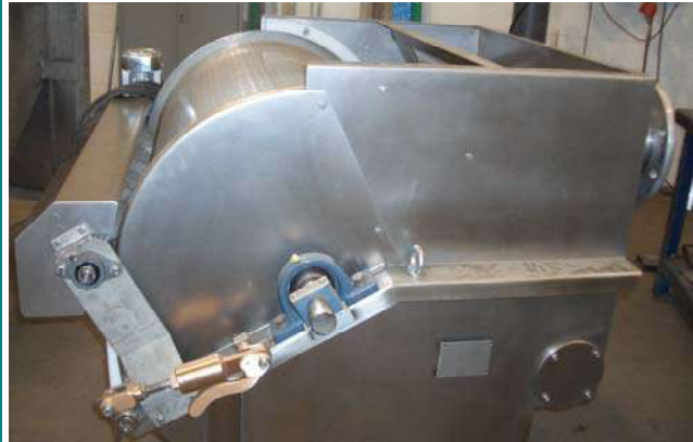
FD CON PULIZIA A SPAZZOLA ROTANTE FD CLEANING BY ROTATING BRUSH
